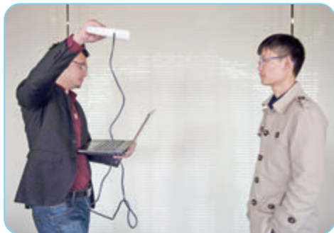
图1.2.10 利用手持三维扫描仪扫描人体
