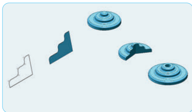
图2.1.16 二维轮廓线经过旋转得到三维模型
