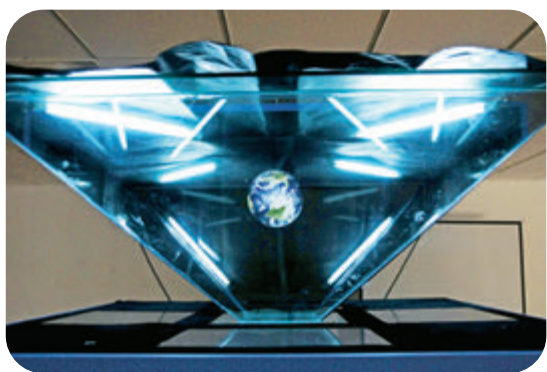
图1.2.25 三维图像悬浮显示装置
