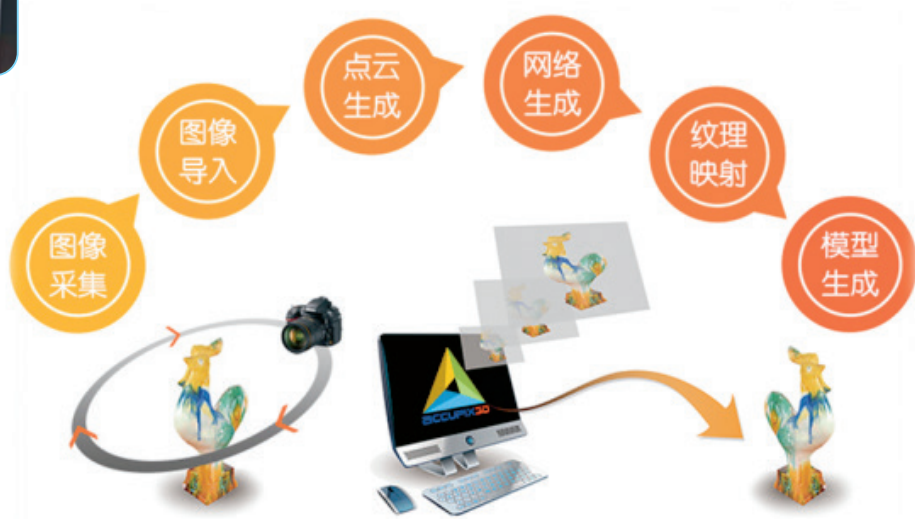
图1.2.8 基于图像的三维重建过程
